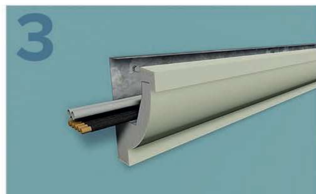
Instalación de moldura
